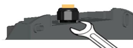
Abb. 6-15: Kabelverschraubung von der Rückseite festziehen
