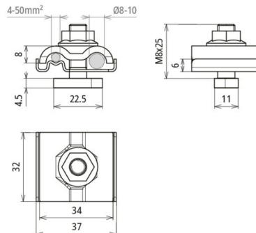
Erdungsklemmen zum Einbinden der Montagesysteme z. B. von PV-Anlagen in den Funktionspotentialausgleich/Funktionserdung (Leiterfarbe ggf. schwarz) und Blitzschutz-Potentialausgleich nach DIN EN 62305-3 (VDE 0185-305-3)
