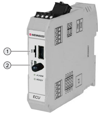
Abb. 24: Anschlüsse auf der ECU
