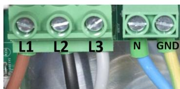
Abbildung 3 – Wechselrichter-AC-Klemmen
