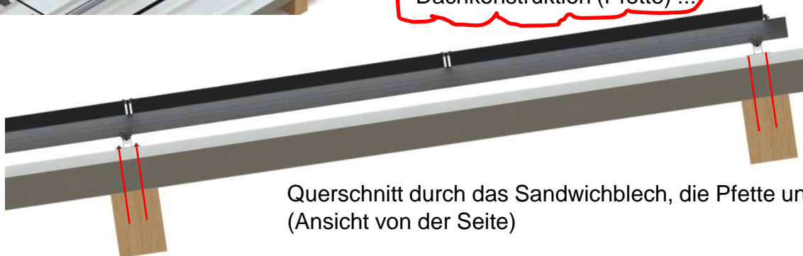
Querschnitt durch das Sandwichblech, die Pfette und die PV-Anlage (Ansicht von unten)
