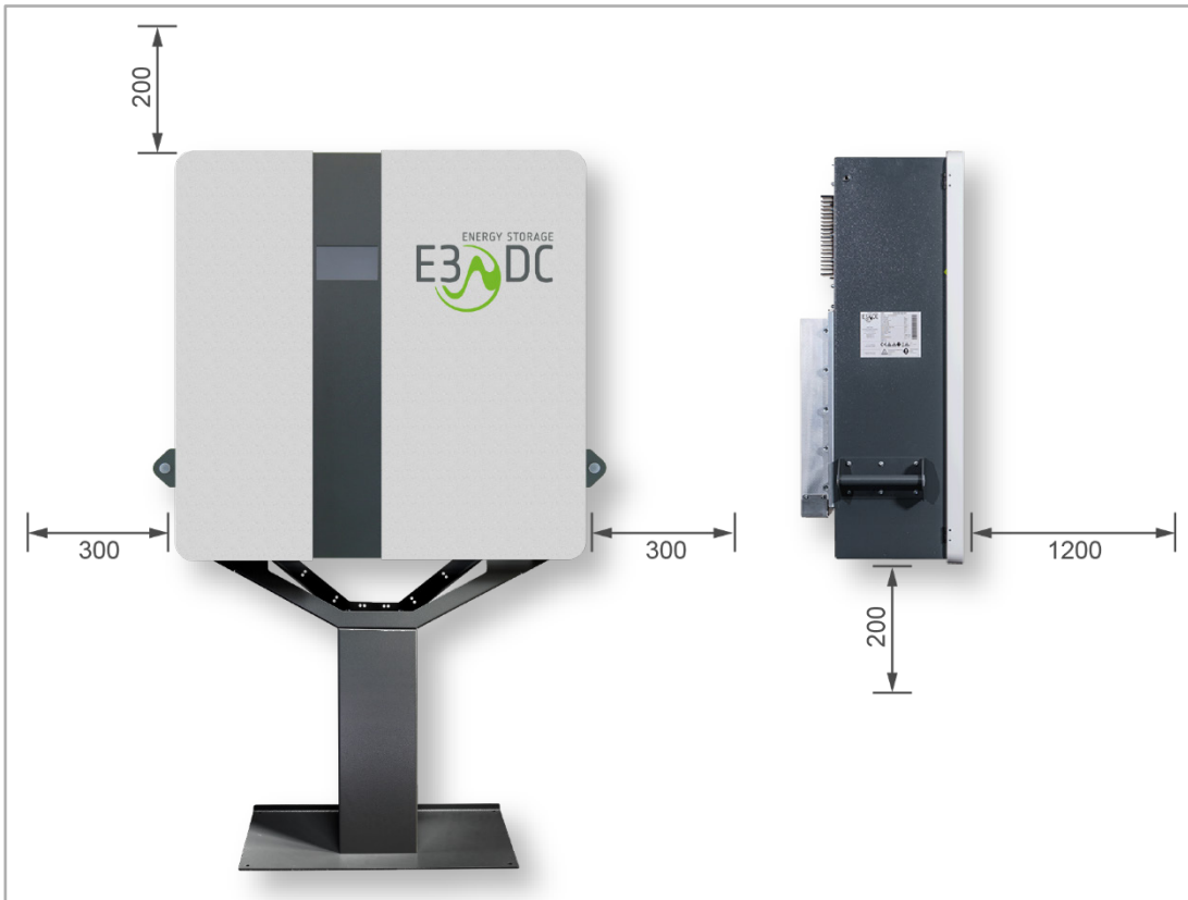
Abb. 7: Mindestabstände zu den Raumwänden | zur Raumdecke | zum Boden | nach vorn (in mm) (Abbildung ähnlich)
