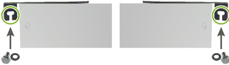
Abb. 23: Kippschutzbügel an der Montagewand befestigen (Abbildung ähnlich)
