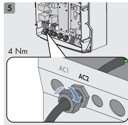
**en** Connecting the AC cable for the battery-backup system **de** AC-Kabel für Ersatzstromsystem anschließen
