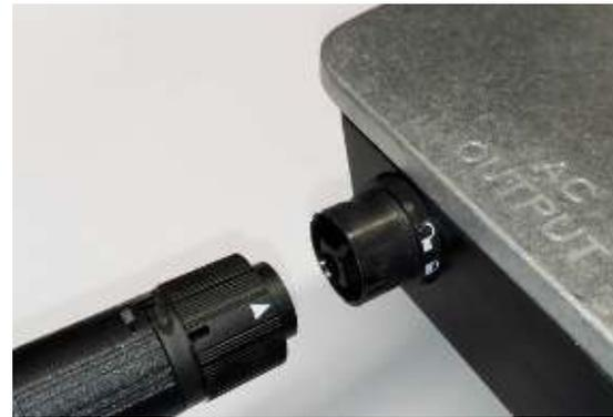
Überprüfen Sie die korrekte Verriegelung des Steckverbinders, in dem der weiße Pfeil auf das geschlossene Verriegelungssymbol zeigt.
