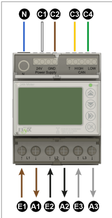
Abb. 2: Externen Leistungsmesser anschließen
