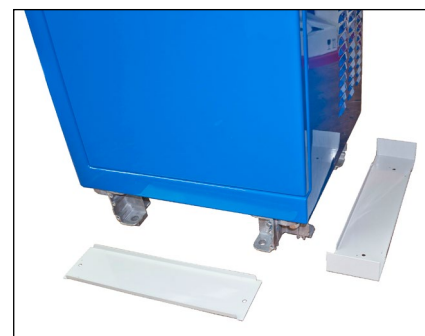
Abb. 41: Sockel-Blenden ECC 320 demontiert
