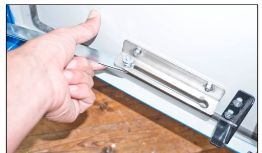
Abb. 18: Entriegeln der Türarretierung
